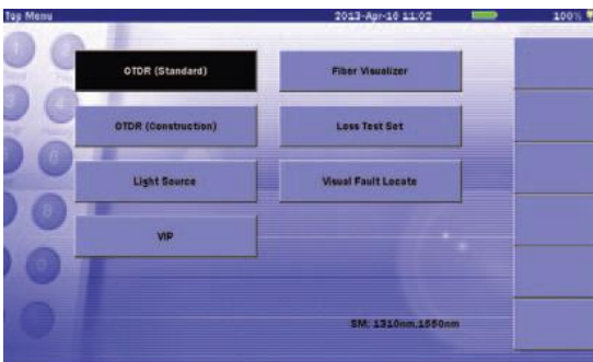
Рис.6: Выделенные режимы измерения для упрощения тестирования при любом уровне навыков
