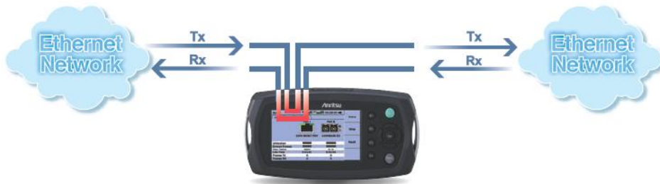
Сквозной мониторинг сети с помощью тестера. Для этого применения используются Tx и Rx двух портов
