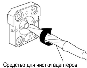
Рисунок 7.4-2 Очистка торцевой поверхности наконечника 2
