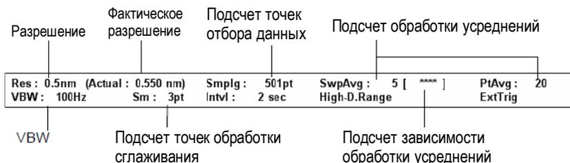
**Рисунок 4.3-1** Поле отображения условий измерения
