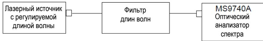
Рисунок 7.2.3-1 Схема измерения динамического диапазона
