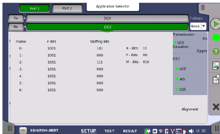
Состояние синхронизации, когда тип цикла M13
