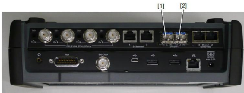
Рисунок 1: Размещение отверстий для лазерного луча
