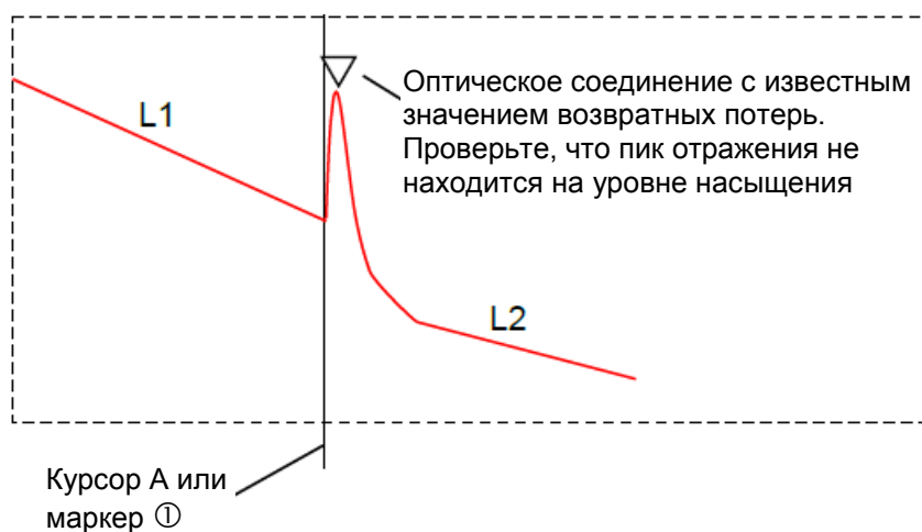
Рисунок 14.4.1-2 Позиция установленного курсора
