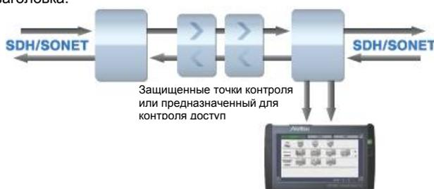
MT1000A поддерживает двунаправленный контроль без перерыва связи линий SDH/SONET
