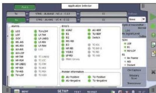
MT1000A обеспечивает быстрый обзор ошибок и аварийных сигналов с обеих сторон линии SDH/SONET
