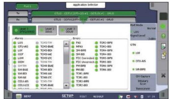
Вид аварийных сигналов и ошибок OTU
