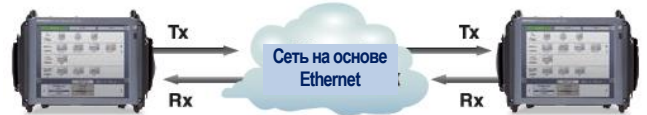
Выполнение теста активации услуг в конфигурации местный-удаленный при использовании двух тестеров MT1100A
