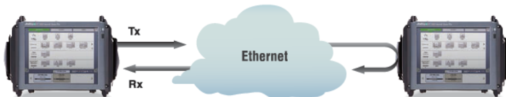
Тест с одного конца при использовании MT1100A как отражателя Ethernet
